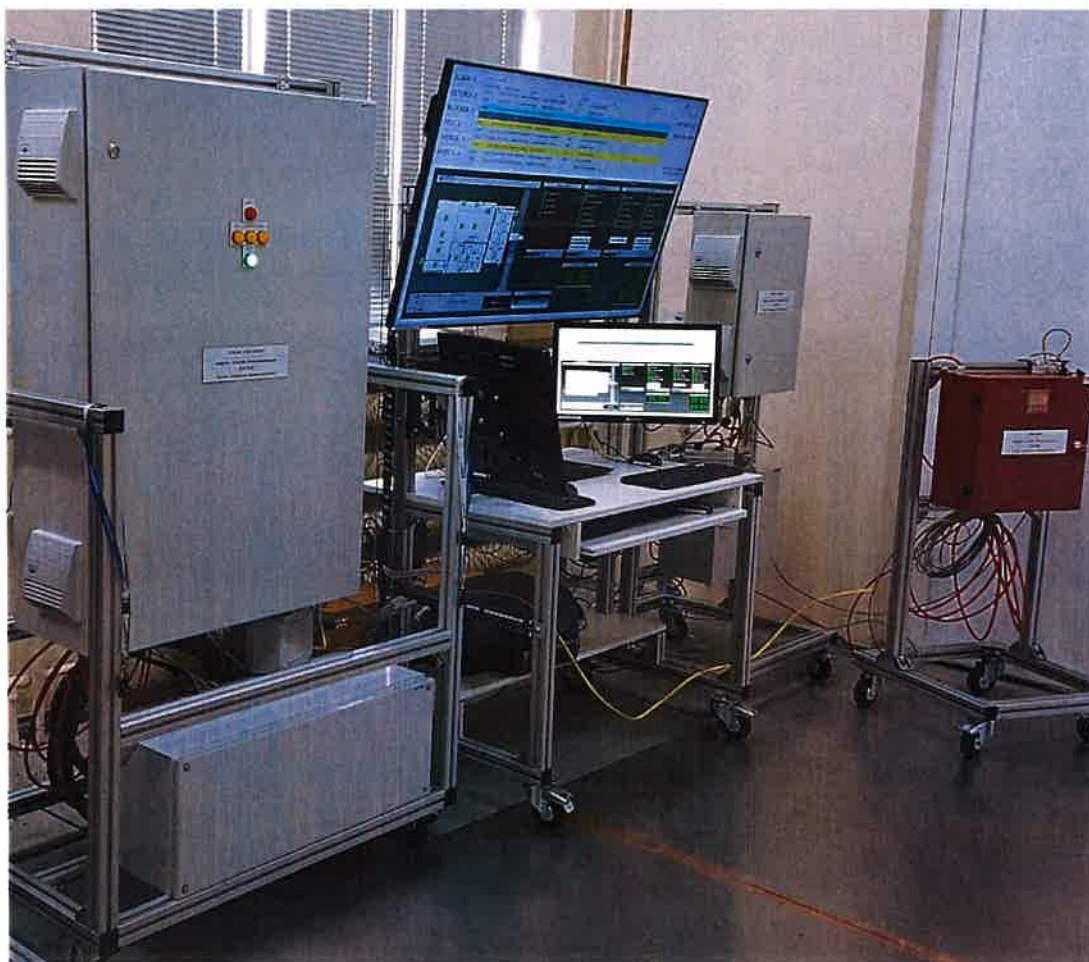
Fot. Nr 1. Widok zewnętrzny całego systemu integrującego urządzenia przeciwpożarowe typu ZEW.SMS w odmianach ZEW.NG-REDUNDANT, ZEW.NG-SINGLE oraz ZEW.NODE.
